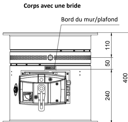
L'étiquette "BUILT IN EDGE" indique le bord recommandé de la construction coupe-feu (mur/plafond). Le clapet doit être installé de manière à ce que l'ensemble du clapet (en position fermée) se trouve dans la construction coupe-feu (mur/plafond) et qu'en même temps le mécanisme et les ouvertures d'inspection soient librement accessibles.
