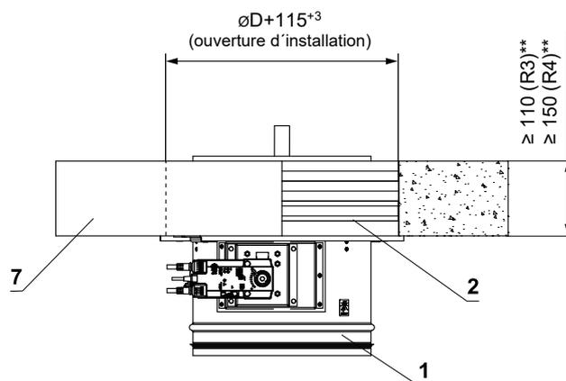
\*\* min. 110 mm - Béton - pour EI 90 S - Cadre de montage R3
