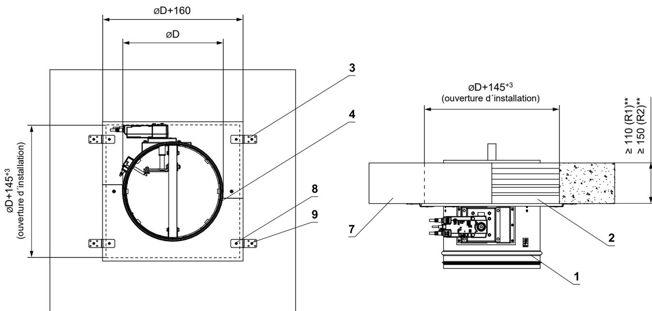
\*\* min. 110 mm - Béton - pour EI 90 S - Cadre de montage R1
