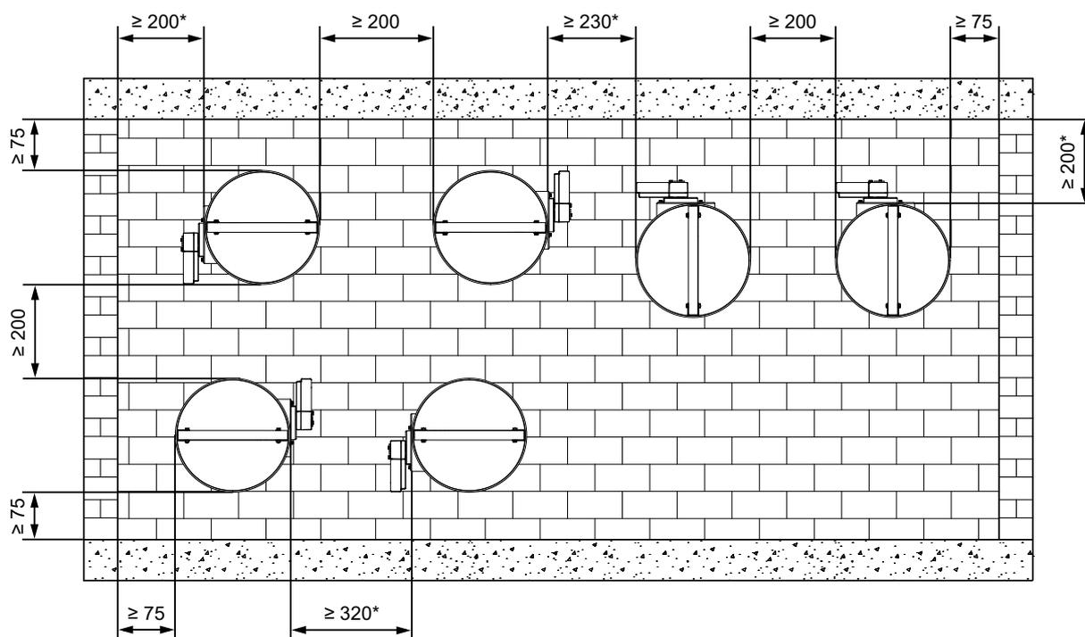
\* Distance minimale recommandée nécessaire pour accéder au mécanisme MODULAR
