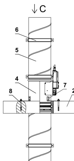
Dans le mur en plaques de plâtre
