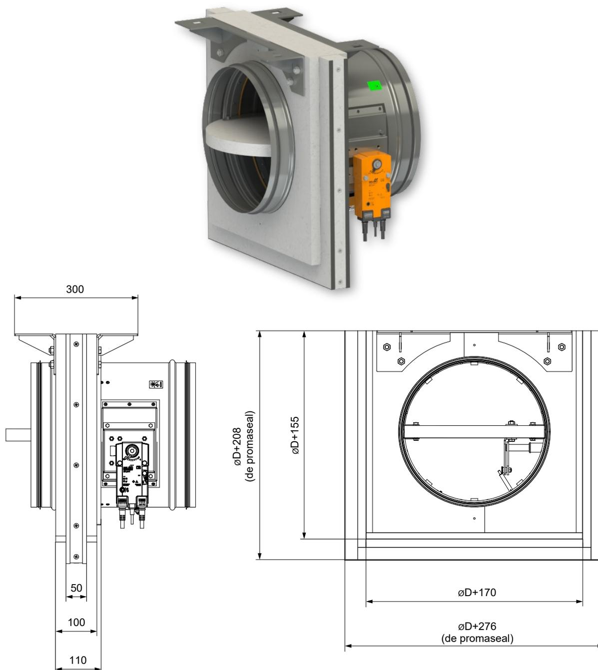
Dans le mur en plaques de plâtre - sous plafond mobile - cadre de montage R7
