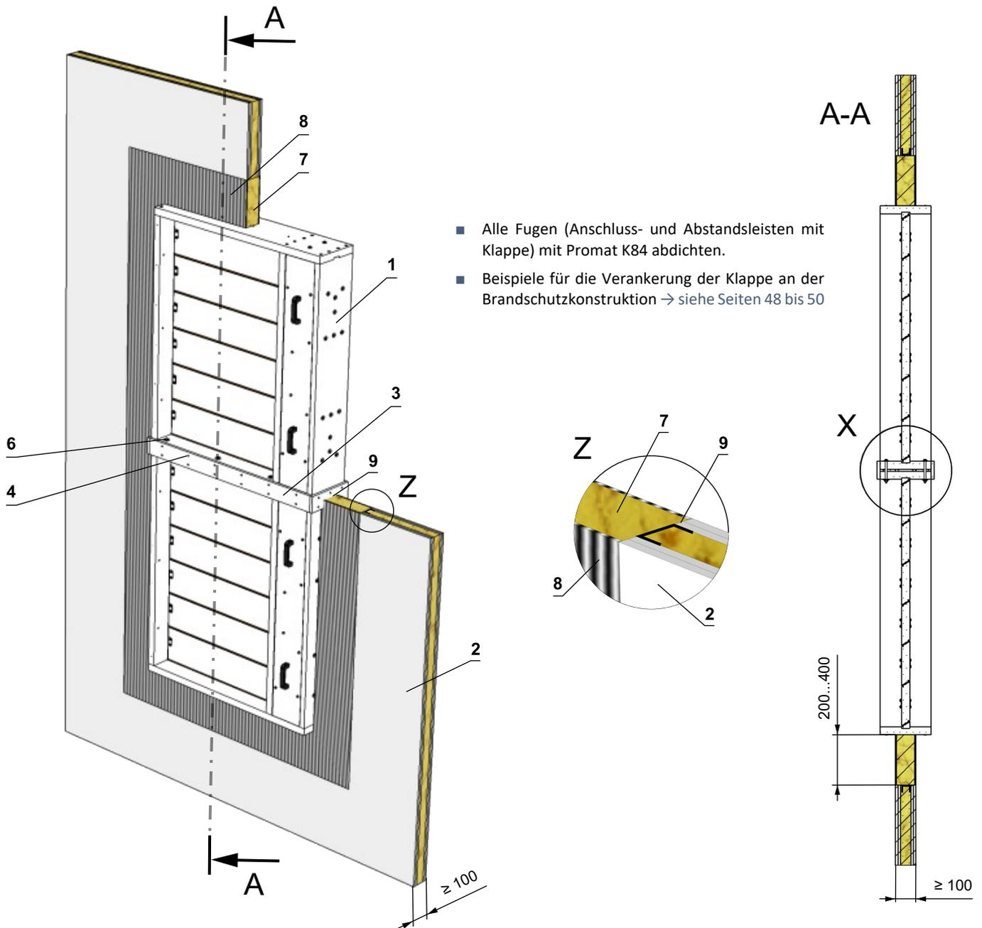
\* Wenn ein Flansch montiert ist, wird der Überlappungsstreifen nicht angebracht.
