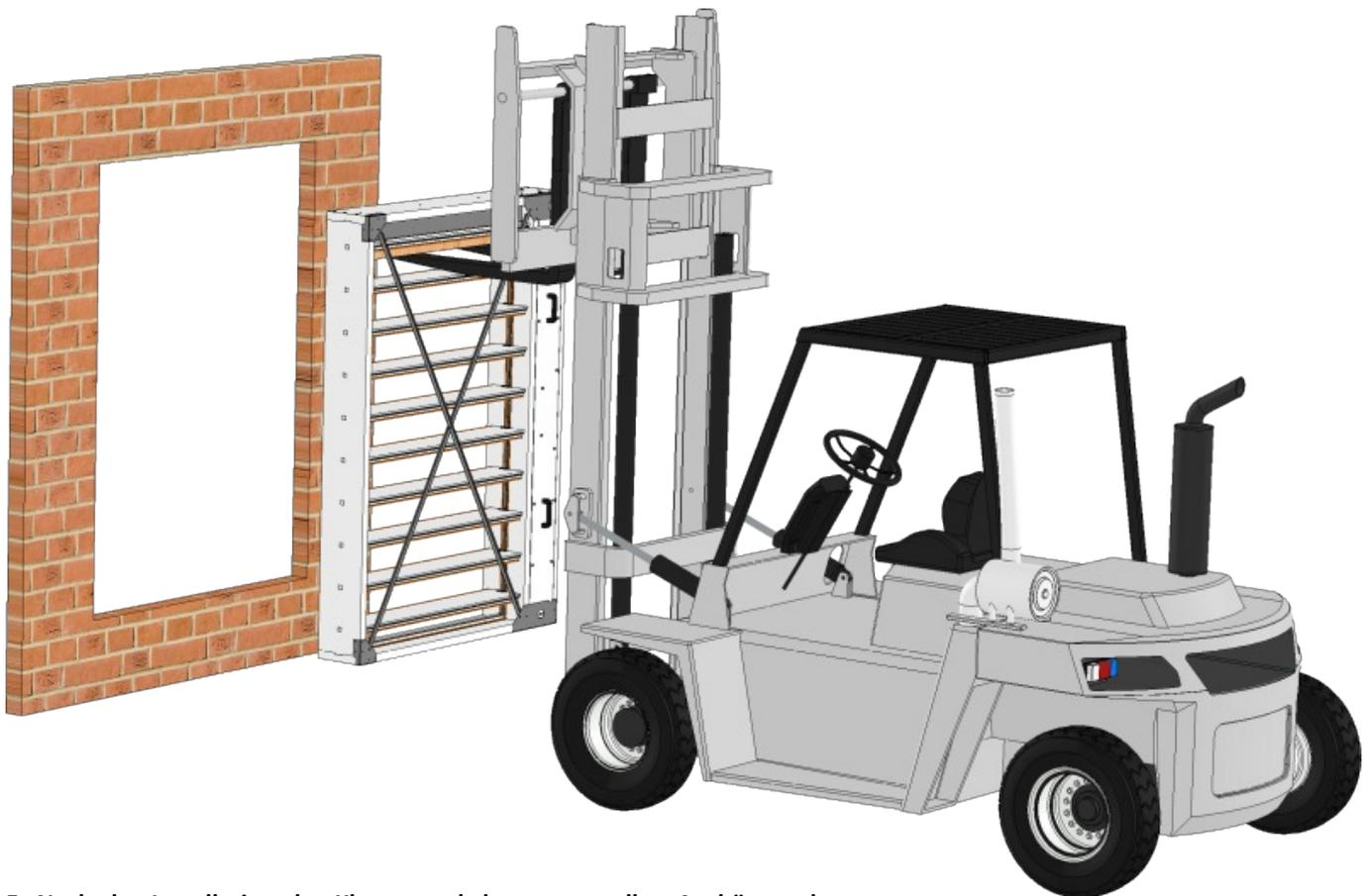
5. Nach der Installation der Klappe und dem eventuellen Aushärten des Gipses/Mörtels, entfernen Sie die Transportstreben und Ecken.
