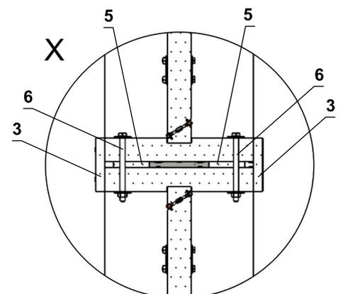
Überdeckungsstreifen, Distanzstreifen, Schrauben und Schraubverbindungen können optional auf Wunsch geliefert werden.
