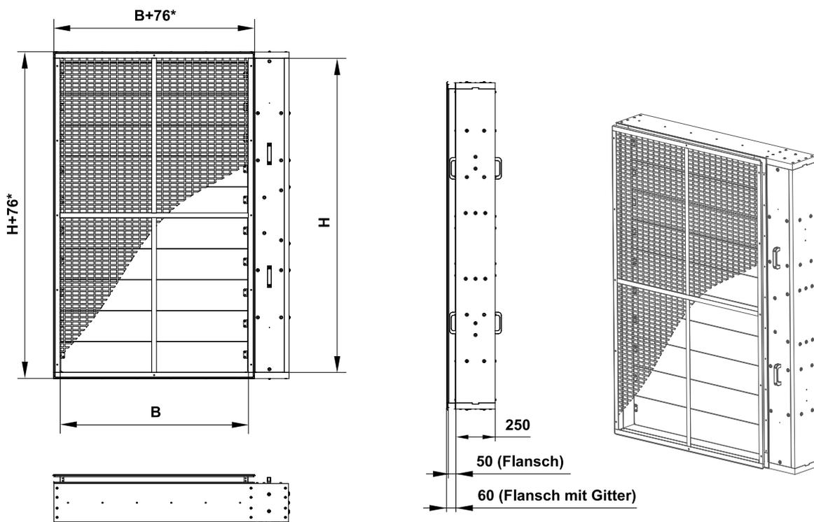
SEDM-L mit Flansch und Abdeckgitter über Klappe
