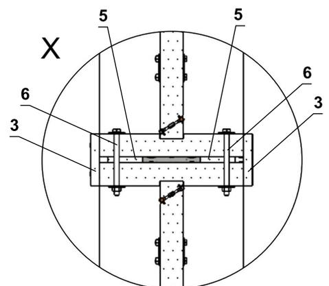
Überdeckungstreifen, Distanzstreifen, Schrauben und Schraubverbindungen können optional auf Wunsch geliefert werden.
