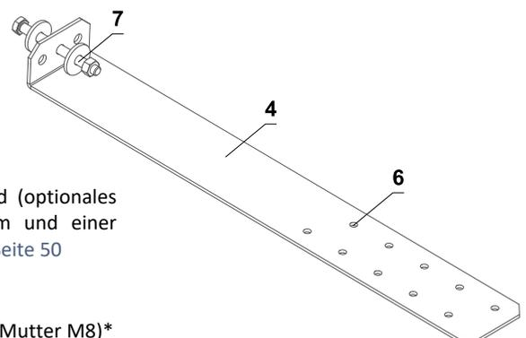
Befestigungselement/Stahlbügel zur Befestigung der Klappe an der Wand
