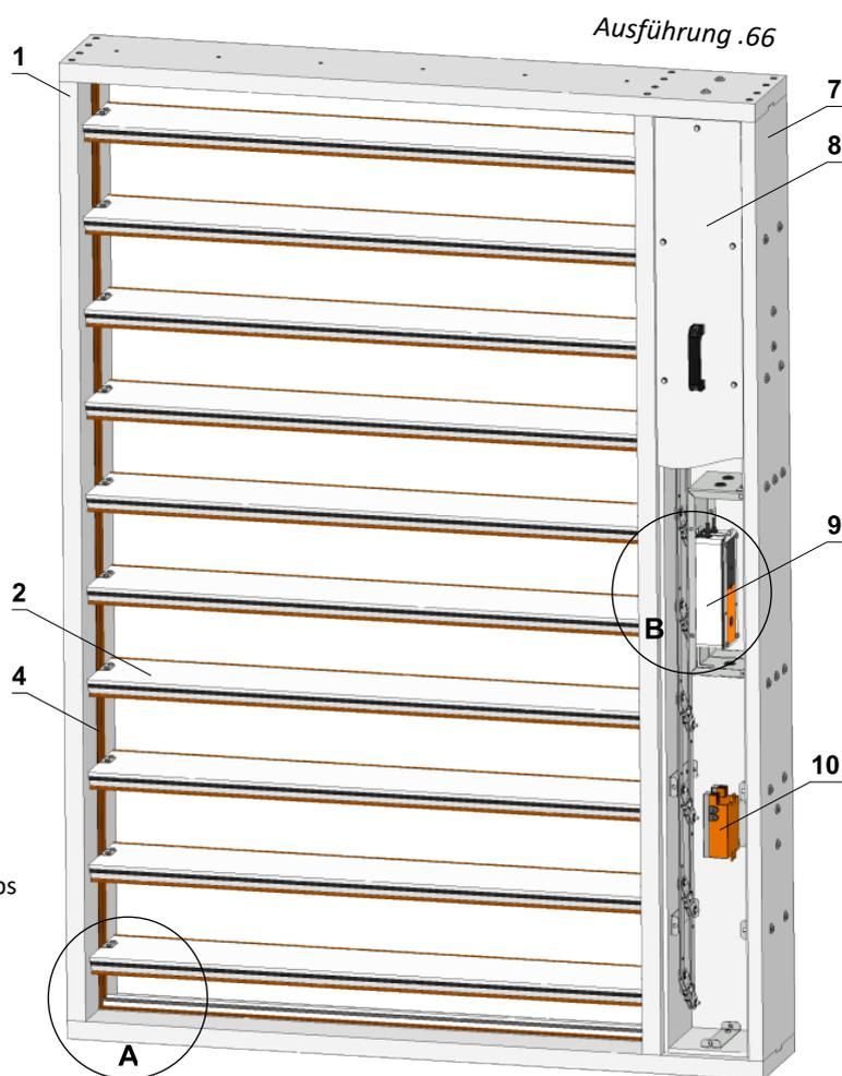
Kommunikations- und Stromversorgungsgeräte BKNE 230-24, mit Servoantrieb BEN 24(-ST), BEE 24(-ST), BE 24-12(-ST)
