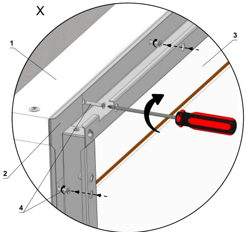
\* Befestigen Sie alle Löcher rund um den Umfang des Flansches.
