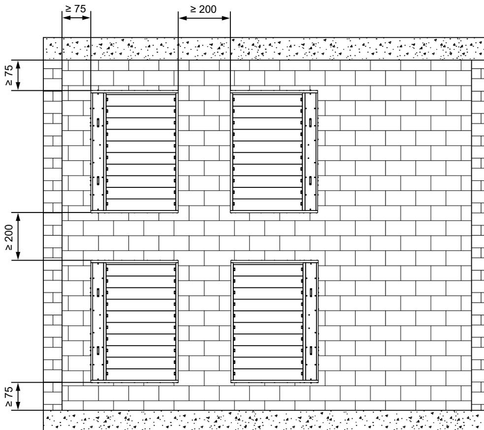
Abmessungen der Einbauöffnungen
