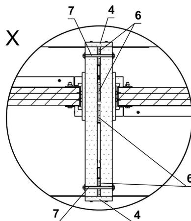
Abb. 49 2 Klappen nebeneinander - Massive Wandkonstruktion - Weichschott
