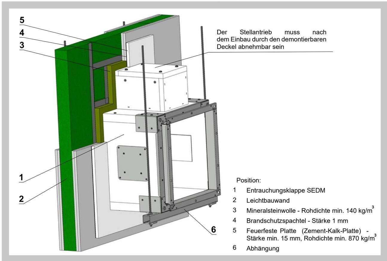
Abb. 39 Leichtbauwände - Nasseinbau - Gips oder Mörtel
