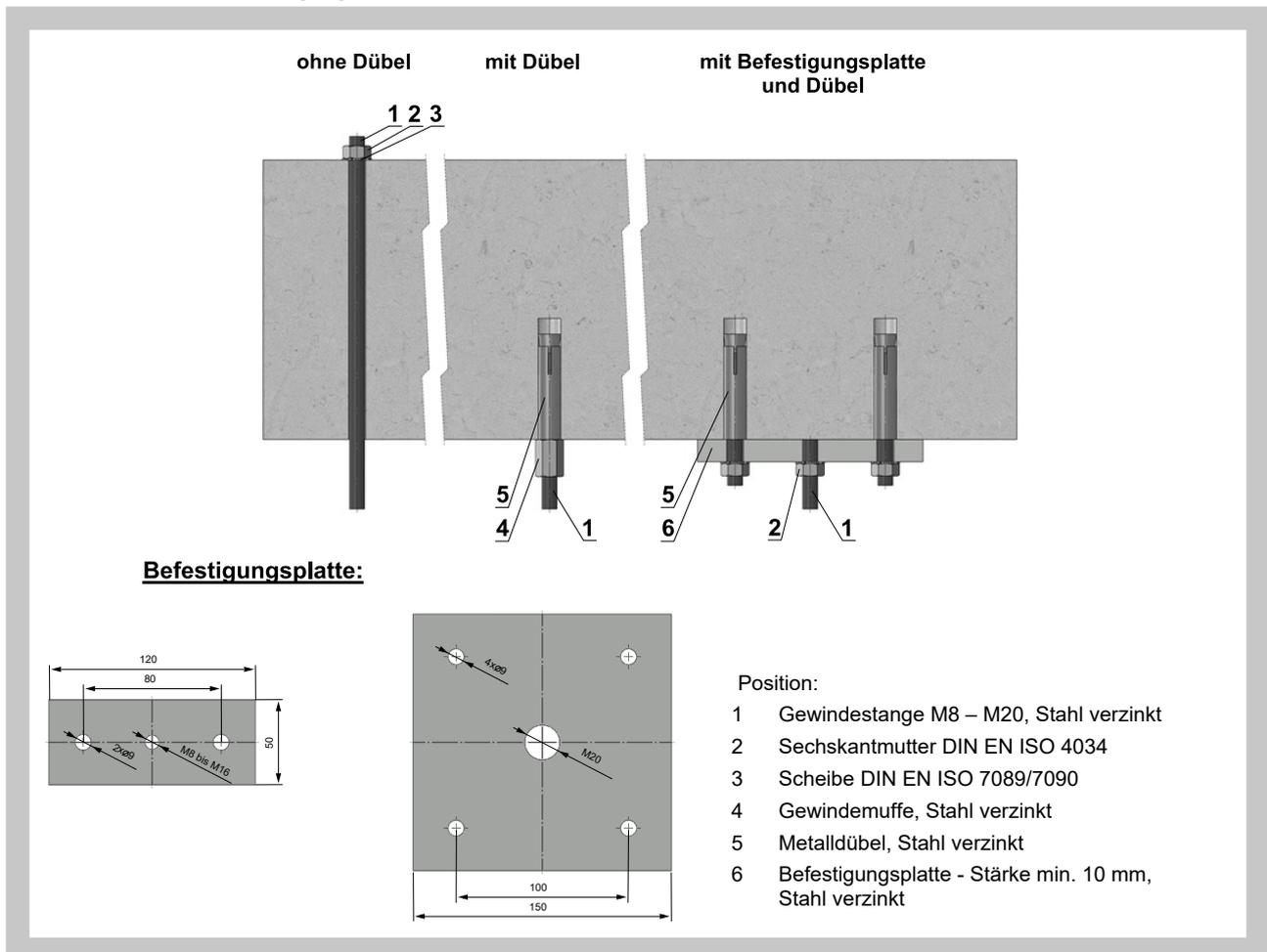
Die Entrauchungsklappen können mittels Gewindestangen und Montagehalter abgehängt werden. Die Dimensionierung der Gewindestangen ist von dem Gewicht der Klappe abhängig.
