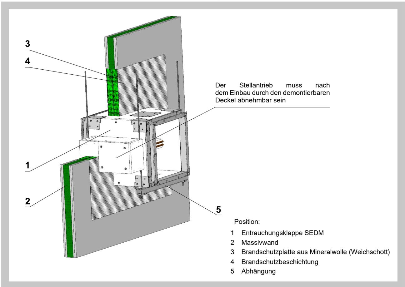
13. Einbau direkt an Massivwände
