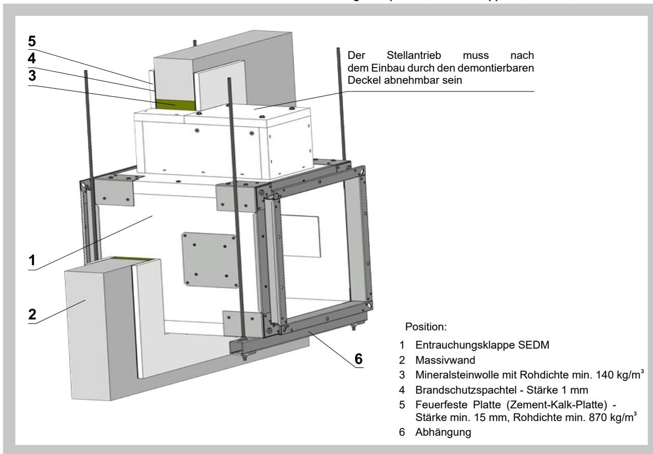
Abb. 27 Massivwände - Trockeneinbau - Brandschutzdichtung mit Spachtelmasse - Klappenblatt horizontal
