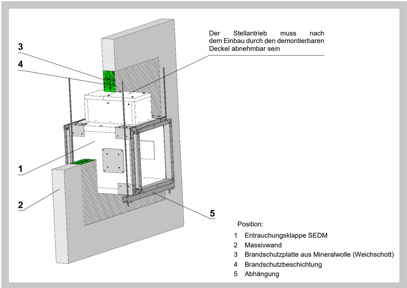
Abb. 31 Massivwände - Trockeneinbau - Weichschott - Klappenblatt horizontal
