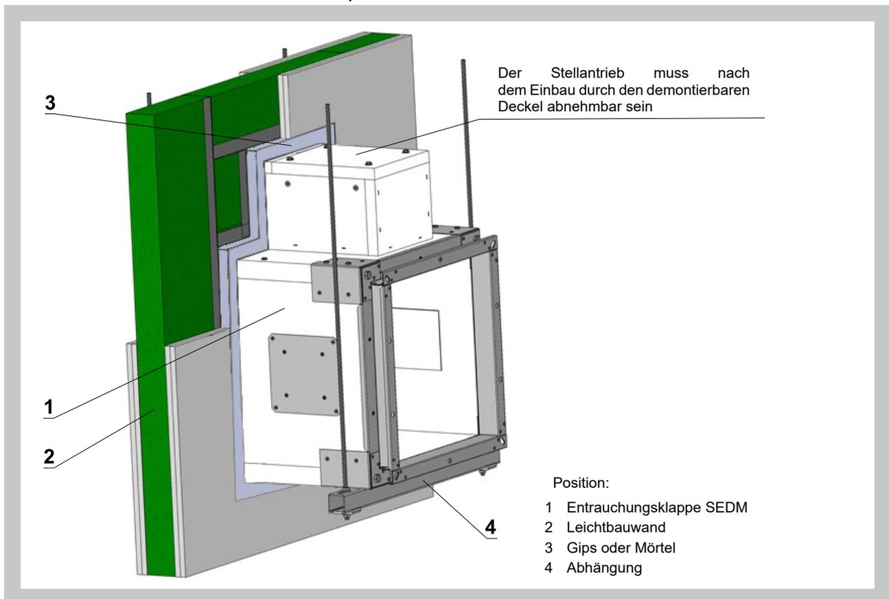
Abb. 40 Leichtbauwände - Trockeneinbau - Weichschott - Klappenblatt vertikal
