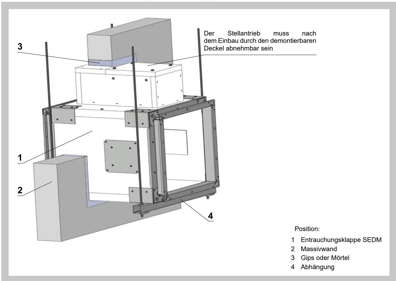
Abb. 29 Massivwände - Nasseinbau - Gips oder Mörtel - Klappenblatt horizontal
