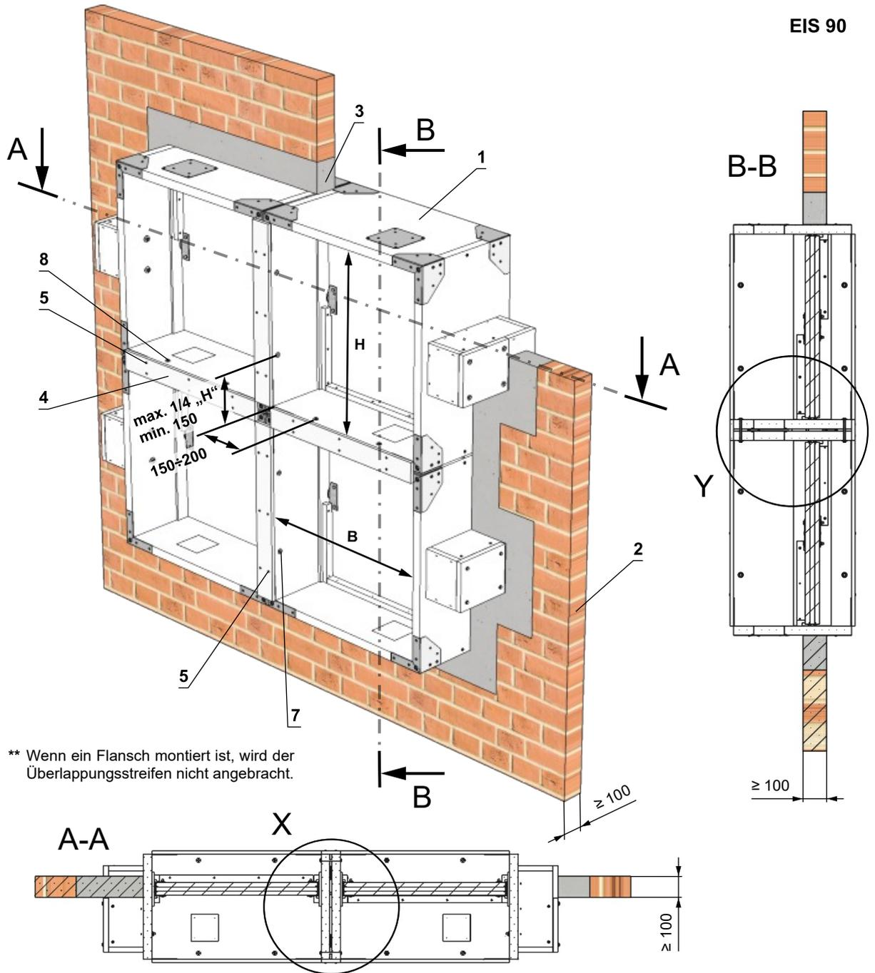
\*\* Wenn ein Flansch montiert ist, wird der Überlappungsstreifen nicht angebracht.
