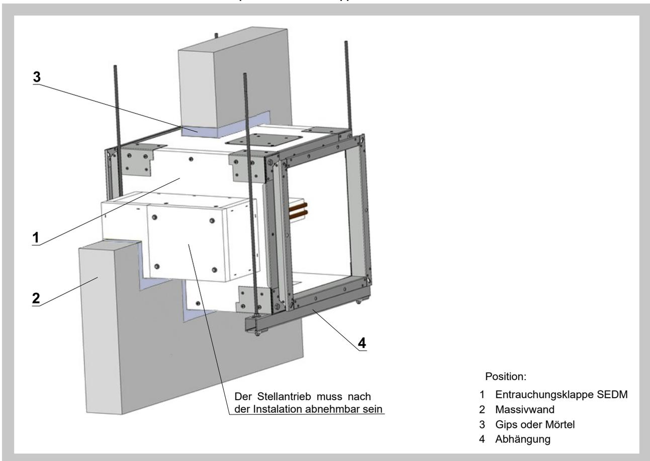
Abb. 30 Massivwände - Trockeneinbau - Weichschott - Klappenblatt vertikal
