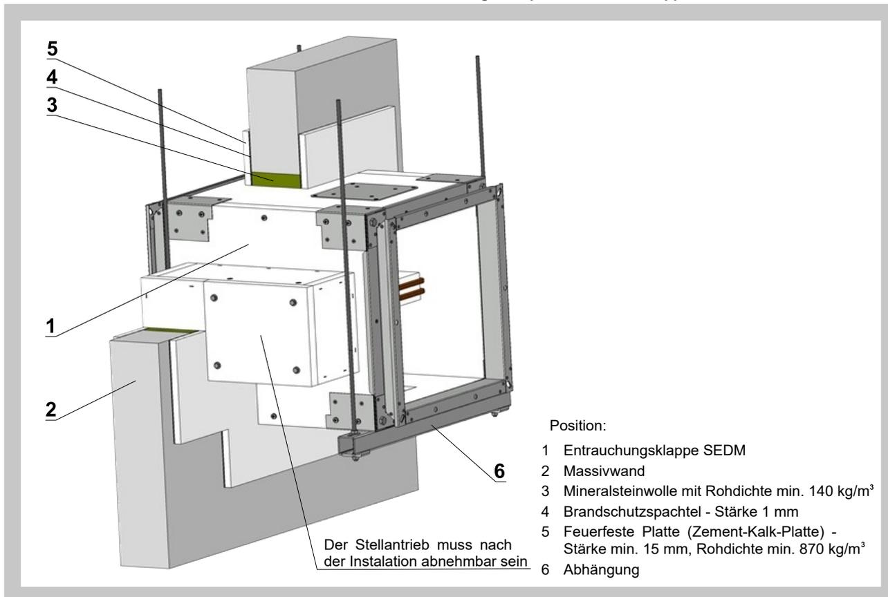
Abb. 28 Massivwände - Nasseinbau - Gips oder Mörtel - Klappenblatt vertikal
