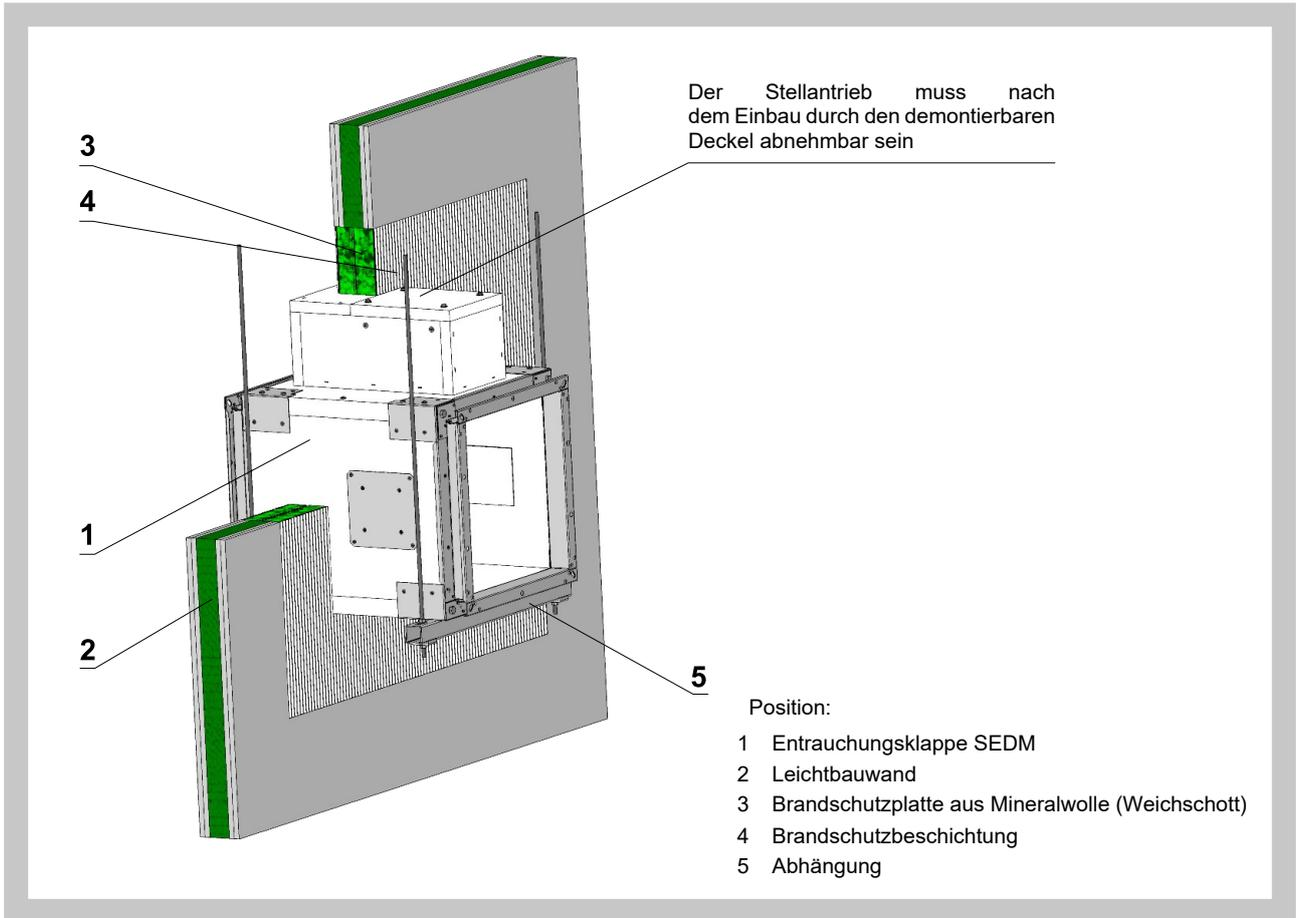
Abb. 41 Leichtbauwände - Trockeneinbau - Weichschott - Klappenblatt horizontal
