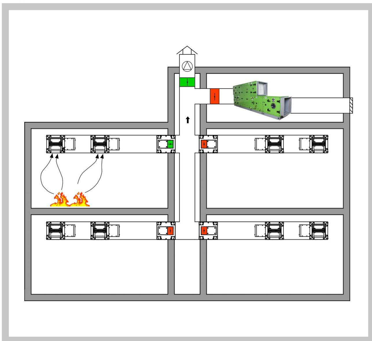
**Entrauchungsanlage - Entlüftungsbetrieb:**
