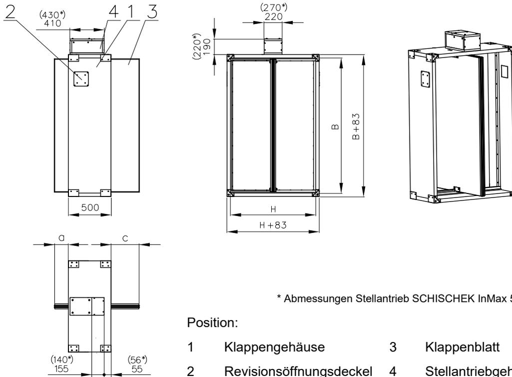
Abb. 19 Entrauchungsklappe - Multi mit Flansch
